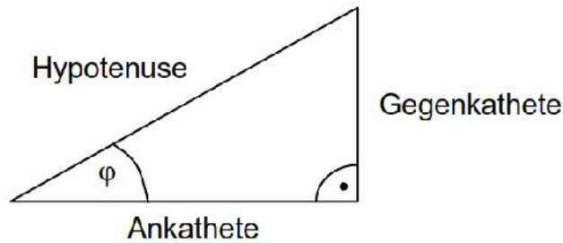
$\sin(\varphi) = \frac{\text{Gegenkathete}}{\text{Hypotenuse}} \rightarrow \varphi = \sin^{-1} \cdot \frac{\text{Gegenkathete}}{\text{Hypotenuse}}$
